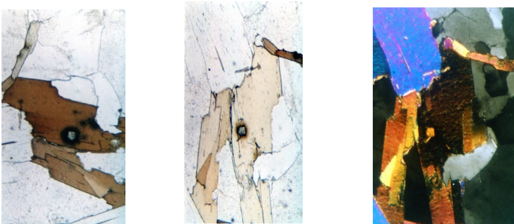
図 8 黒雲母と白雲母の顕微鏡写真。左側と中央は平行ニコルでの写真、右側の写真は直交ニコルでの写真。左側の写真の黒雲母を 90 度右に回転させると中央の写真のようになり、多色性を示すことが分かる。右側の写真は黒雲母が中央の写真の位置にある時に直交ニコルにしたものである。右の写真中で青色の干渉色を示す鉱物は、中央と左側の写真から透明鉱物であることが分かる。この鉱物は白雲母である。なお、平行ニコルの写真中の黒色のハローはメタミクトハローである。ハローの中心にある透明鉱物はジルコンである。
