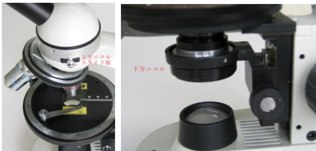
図1 簡易偏光顕微鏡。左側の写真中に赤字で記した板（上方ニコルスライド板）に偏光板が取り付けられている。スライド板の二箇所には穴があり、片方の穴には偏光板（上方ニコル）が埋め込まれている。スライド板を動かして平行ニコルによる観察と直交ニコルによる観察を切り替える。なお、ステージに載せているガラス板が薄片である。右側の写真はステージの下側を示している。この簡易偏光顕微鏡では下方ニコルが円筒状の集光器内に組み込まれている。
