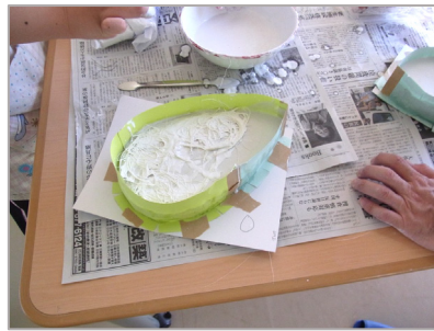
写真12 石膏を流し補強材を入れる
