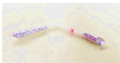
図 3 綿棒の両端をアルミ箔で包む
