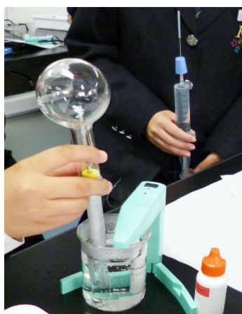
図 2-34 アンモニアの捕集
