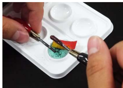
図2-51 銅の析出と脱色の確認（塩化銅(II)水溶液の電気分解）
