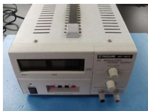
図2-9 一般的な直流電源装置（ヤガミ製）
