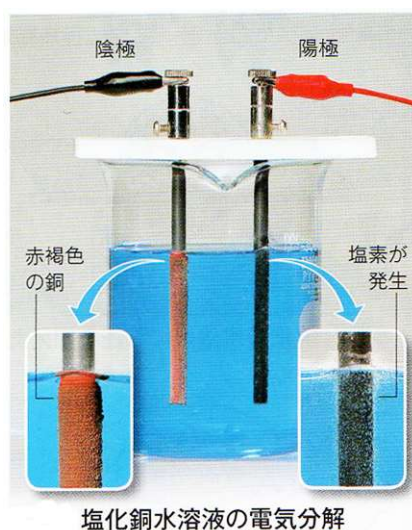
図2-1 中学校理科教科書に記載の実験例 塩化銅(II)水溶液の電気分解 2)
