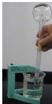
図 2-33 アンモニアの捕集
