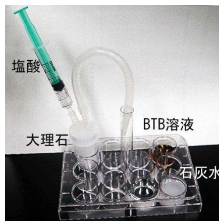
図 2-30 二酸化炭素の発生実験器具
