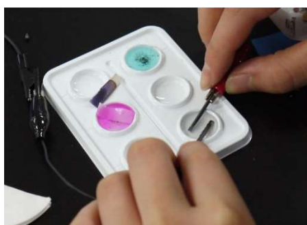
図2-52 呈色板による3種類の電解質溶液の電気分解 ( \text{AgNO}_3 溶液の例)
