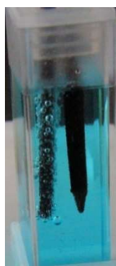
図 2-4 塩化銅(II)水溶液 の電気分解 5)
