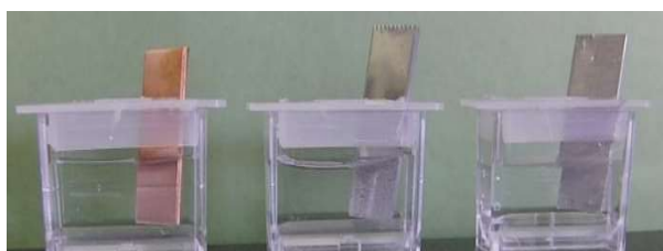
図 2-37 左から希塩酸中に入れた銅, 亜鉛, マグネシウムの金属板
