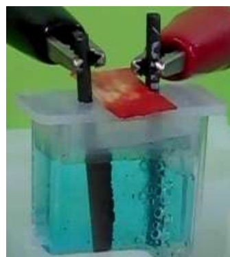
図2-7 本研究で開発したパック テスト容器を用いた塩化銅 (II)水溶液の電気分解 6)
