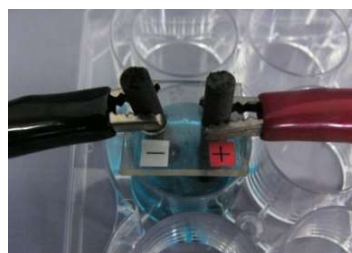
図2-3 セルプレートによる電解槽
