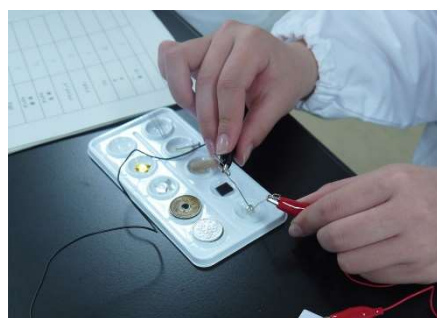
図 2-46 固体試料の導通を調べている様子
