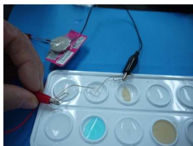
図 2-48 溶液の導通を調べている様子
