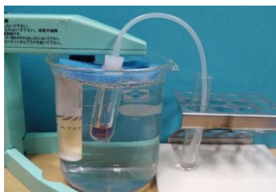
図 2-22 エタノールと食用色素を含む混合溶液の蒸留
