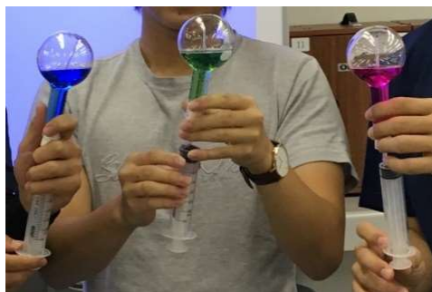
図 3-9 三色のアンモニアの噴水
