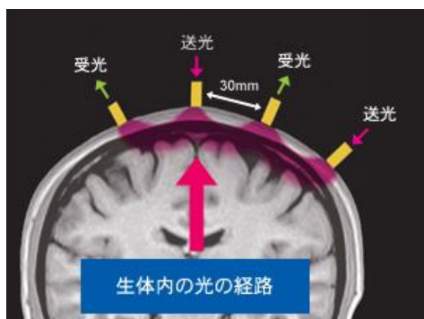
【図2】NIRSの仕組み
