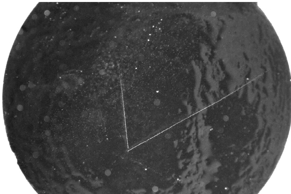
図83a 自然放射線の飛跡（融雪剤（ \text{MgCl}_2 \cdot 6\text{H}_2\text{O} ）を寒剤として使用） 冷却後 3 m06 s, 室温 24.2 °C, 寒剤の温度-34.8 °C ( \pm 1 °C) ^{220}\text{Rn} 起源と思われる \alpha 線の飛跡が見られる.
