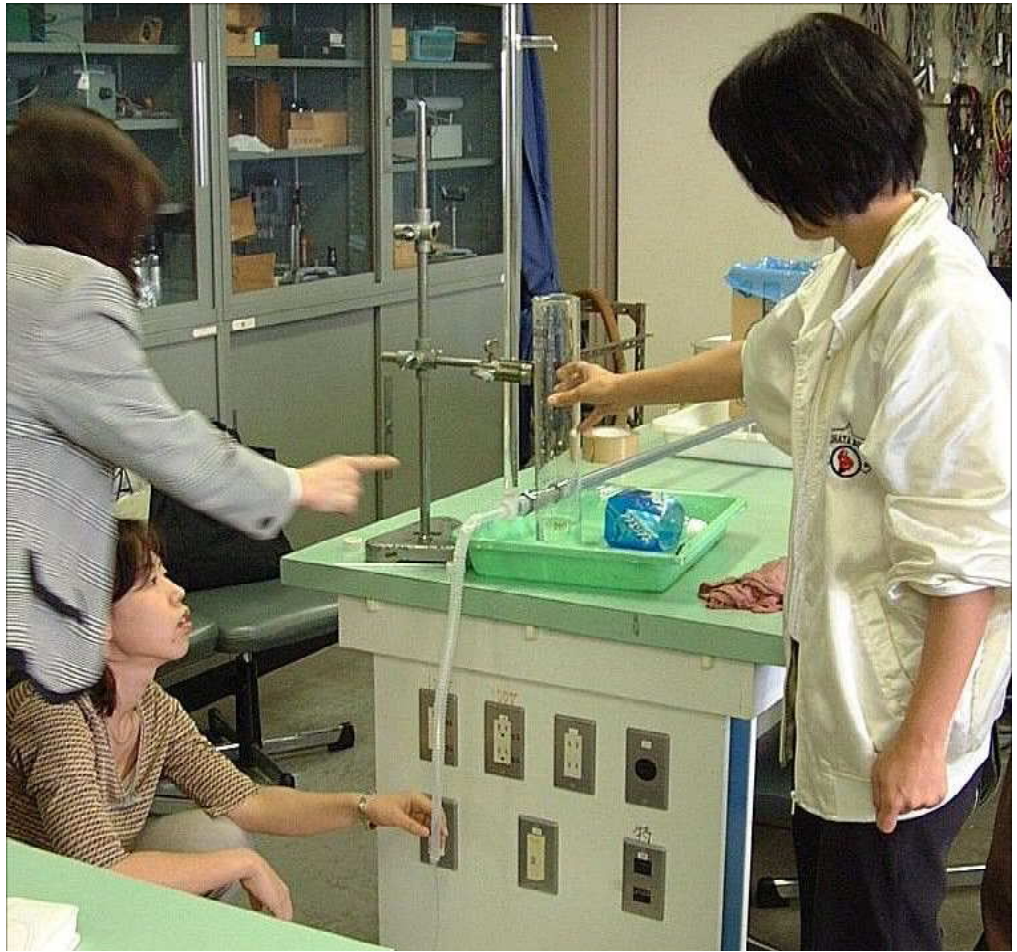
図23 効率を上げる実験の様子 排水部を下に伸ばす工夫をしている。
