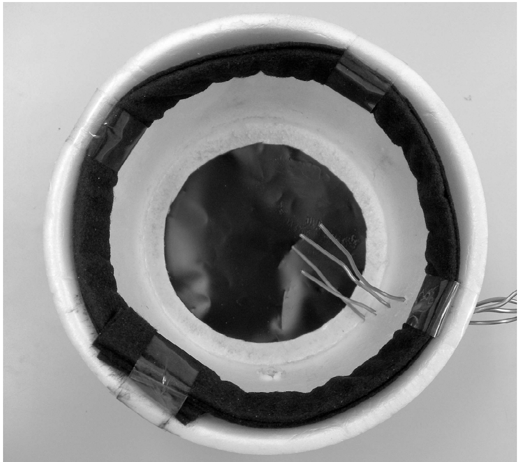
図85 温度測定のための熱電対の設置
