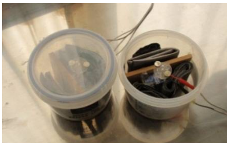
図 4・10 自作の防水型マグネチックスターラー 50)
