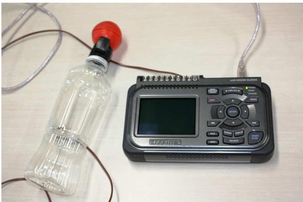
写真 4-1 雲づくりの実験のための実験装置
