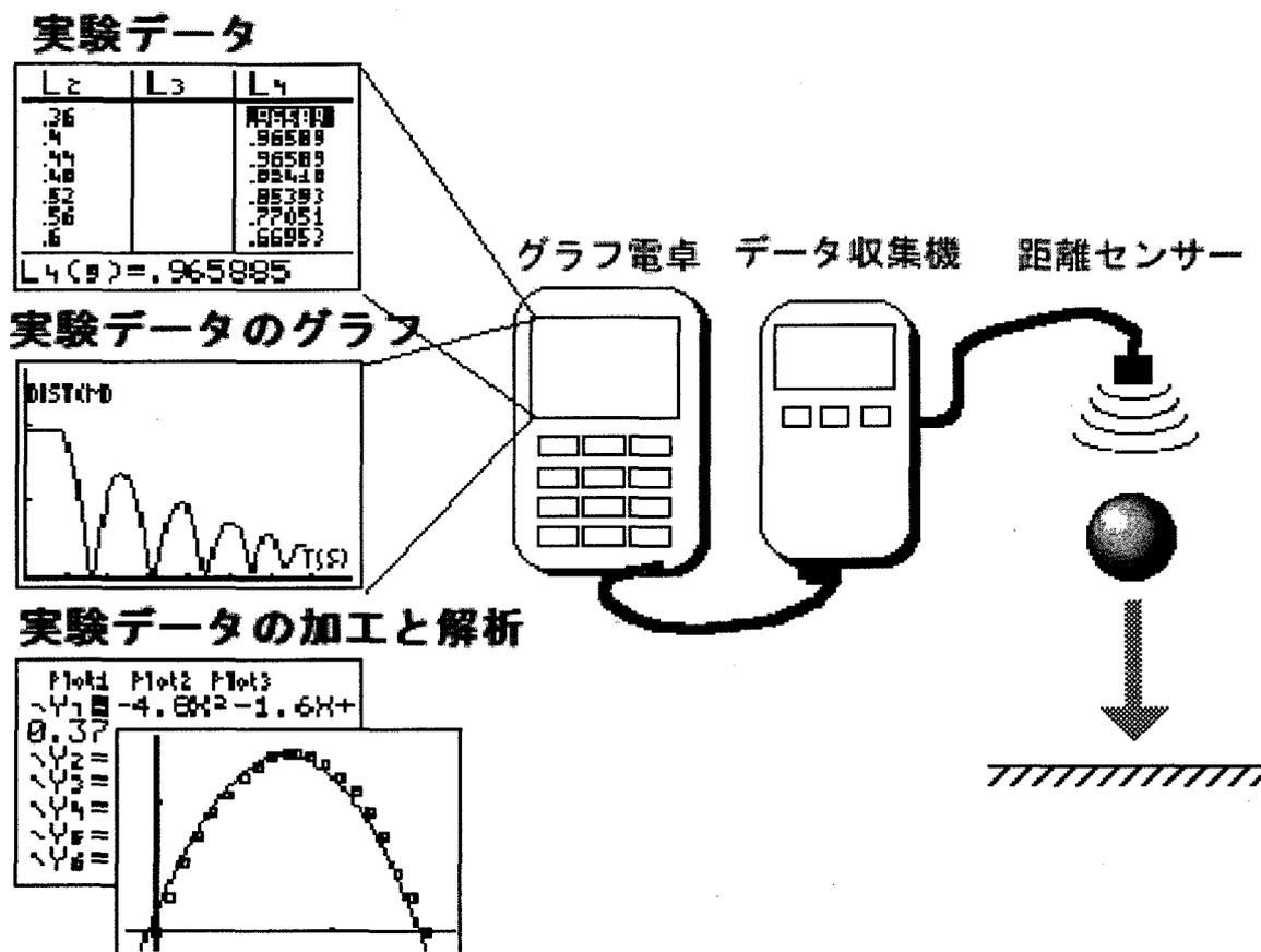
図 1-2-3. 実験装置例 (ボールの実験)
