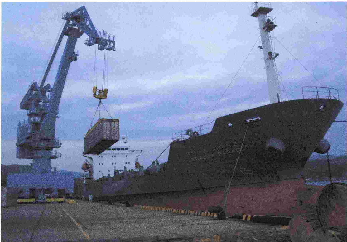
写真 2 多目的クレーンによる積荷
