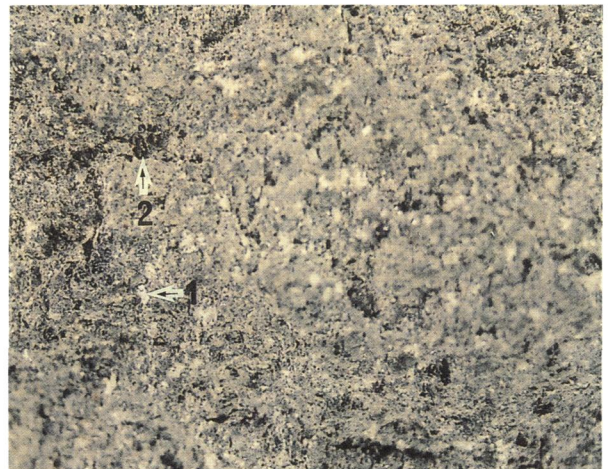
図3 安山岩の標本写真。写真中で番号を付けた粒子は、1が斜長石、2が輝石である。写真の横幅は8.4cmに相当する。
