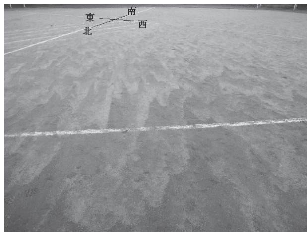
図3 噴出口からの水の流れの痕跡
