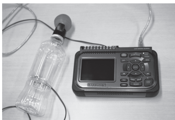
図 7 雲づくりのための実験装置
