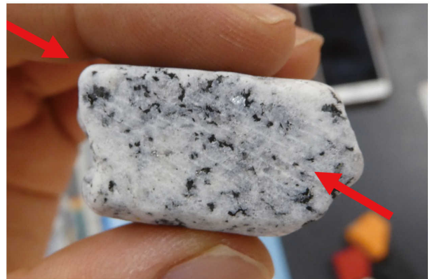
図8 試料平面部で見られる擦り傷。矢印の方向に傷がついている。
