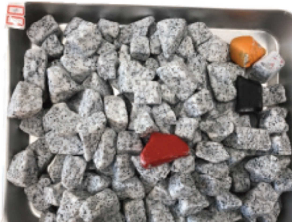
図7 森本の実験用試料。実験前の試料全体（上）と5回目のタンブリングを行う前の試料全体（下）。
