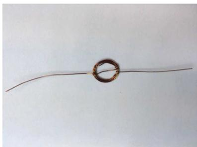
(b) 軸の長さ不適切・直線性不良
